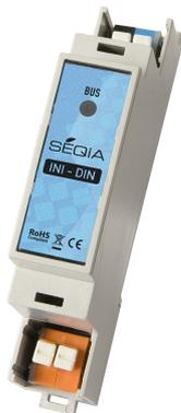
**Establece el BUS de comunicación del sistema SÉQIA, SQ-BUS, para un solo segmento.**
